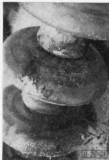
21. ábra. Közberső talppontok által okozott jellegzetes sérülések
